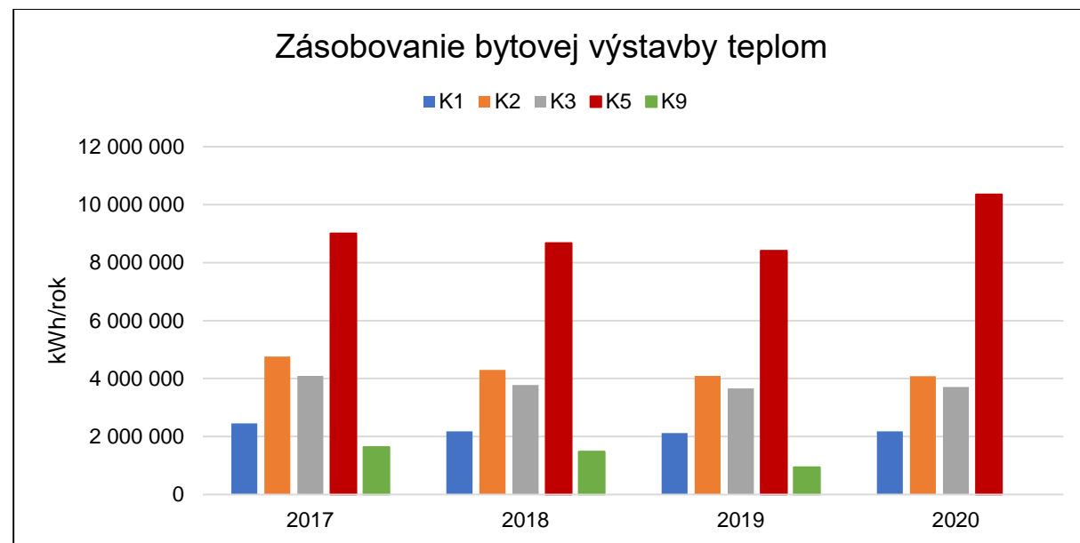
Obrázok 16: Zásobovanie bytovej výstavby teplom, kotolňa K5 zásobuje aj bývalý okruh K4 a od 09/2019 aj okruh K9
